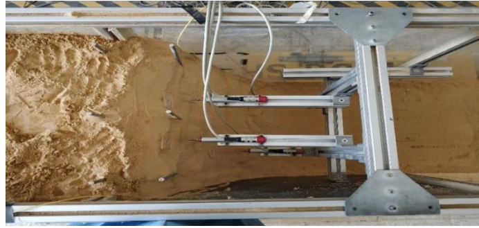
Şekil 2. Heyelan simülatörü deney düzenekinin plan görüntüsü
