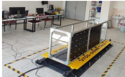
Şekil 1. Sarsma tablası ve heyelan havuzunun kurulum aşamasındaki görünümü
