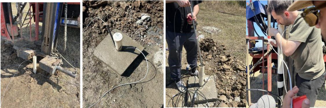
Şekil 10. Inklinometre borularına sabitlenmiş fiber optik kablo ve inklinometre ölçümü
