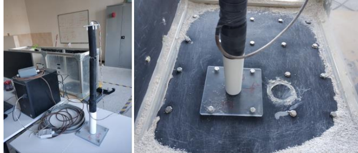
Şekil 3. Eğim borusunun sensör kablo bağlantıları ve sarsma tablası içindeki yerleşimi
