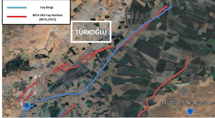
Şekil 9. Deprem sonrası oluşan fay kırığı harita görüntüleri (Aktif faylar MTA, 2012'den alınmıştır)
