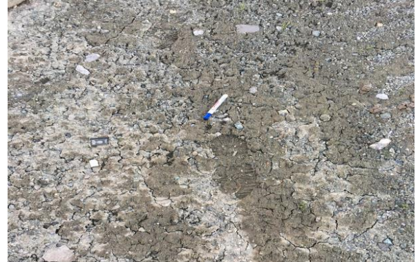
Şekil 11.(b). Türkoğlu ilçe merkezi güneyindeki sanayi bölgesindeki dolguda yumuşama görseli (Fotoğraflar: Koçkar, 2023)
