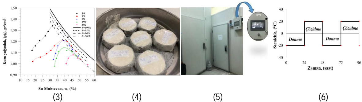
Şekil 3. Kompaksiyon verileri, Şekil 4. Tek boyutlu ödometre deney numunesi, Şekil 6. DÇ kabini, Şekil 6. DÇ uygulanma koşulları
