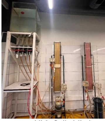
Şekil 3. Geliştirilmiş uzun süreli filtrasyon deney sistemi
