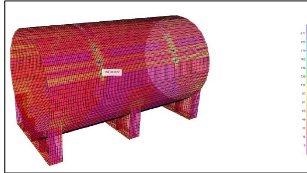
Şekil 14. Von Mises stress sonuçları – UDSTL7
