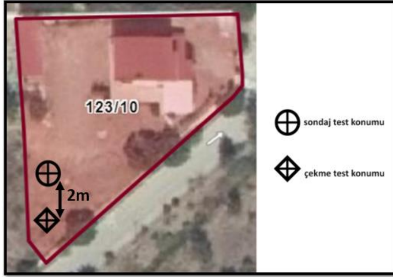
Őekil 3. Proje sahasında sondaj ve ekme testlerinin yapıldığı konum
