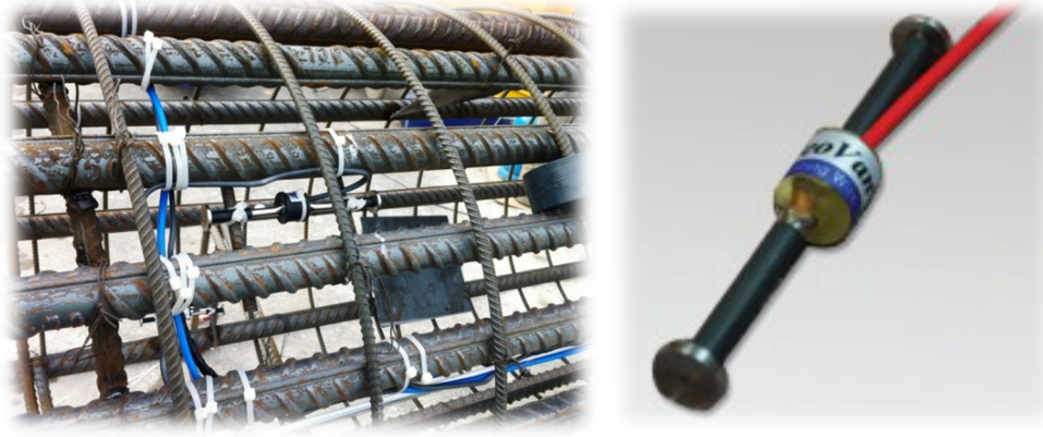
Şekil 8. KYD kapsamında kullanılan titreşen telli gömülü tip birim deformasyon ölçerlerden (vibrating wire embedment type strain gauge, VWSG/E) genel görünüşü.
