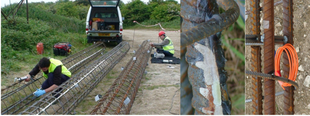
Şekil 24. Fiber bragg grating (FBG) yarı dağınık sensör ile bir kazık yükleme deney hazırlığı (Tatam, 2014).
