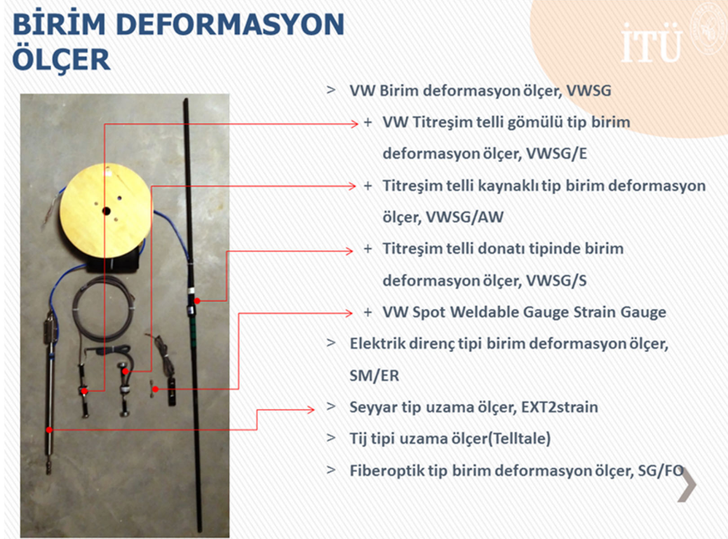
Şekil 7. Geoteknik uygulamalar kapsamında kullanılan birim deformasyon ölçerlerden genel görünüşü (İnanır, 2024).
