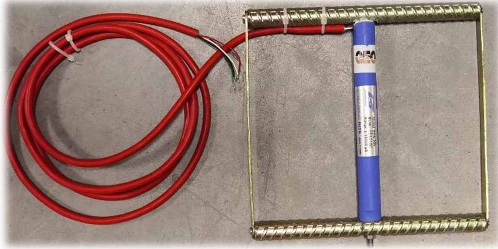
Şekil 12. Tünel tahkimatlarında kullanılan titreşen telli püskürtme beton tipi birim deformasyon ölçerlerden (vibrating wire shotcrete type strain gauge, VWSG/SC) genel görünüş.
