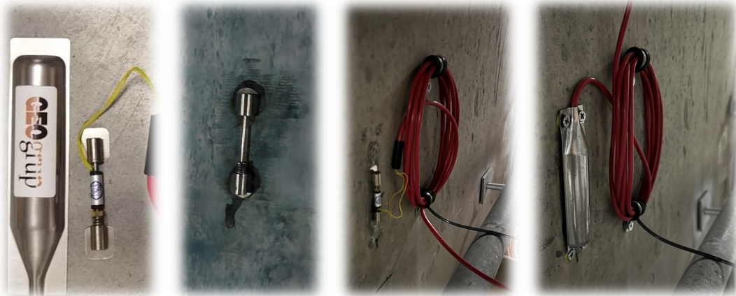
Şekil 9. Beton yüzeyde kullanılan titreşen telli punta kaynaklı tip birim deformasyon ölçerlerden (vibrating wire spot weldable type strain gauge, VWSG/AW) genel görünüşü.
