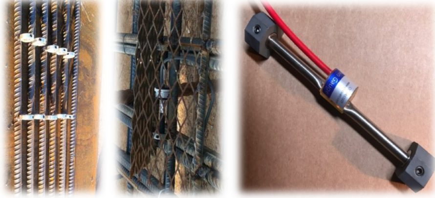
Şekil 10. KYD kapsamında kullanılan titreşen telli kaynaklı tip birim deformasyon ölçerlerden (vibrating wire arc weldable type strain gauge, VWSG/AW) genel görünüşü.
