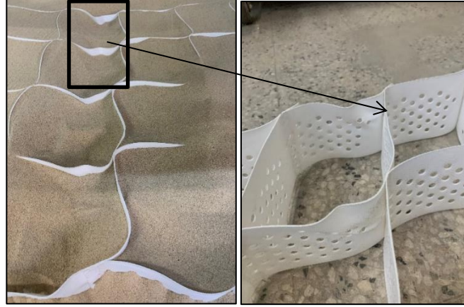
Şekil 4. 150 mm hücre duvarı yüksekliğine sahip geocellin burkulması.
