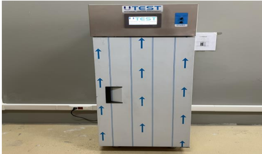
Şekil 3.3. Bilgisayar kontrollü donma-çözünme cihazı
