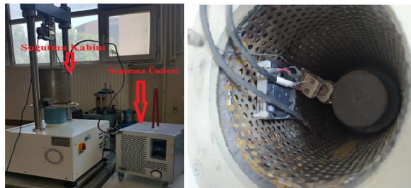
Şekil 2. Soğutma Kabini ve Soğutma Ünitesi Serbest Basınç Deney aletine yerleştirilmiş şekilde
