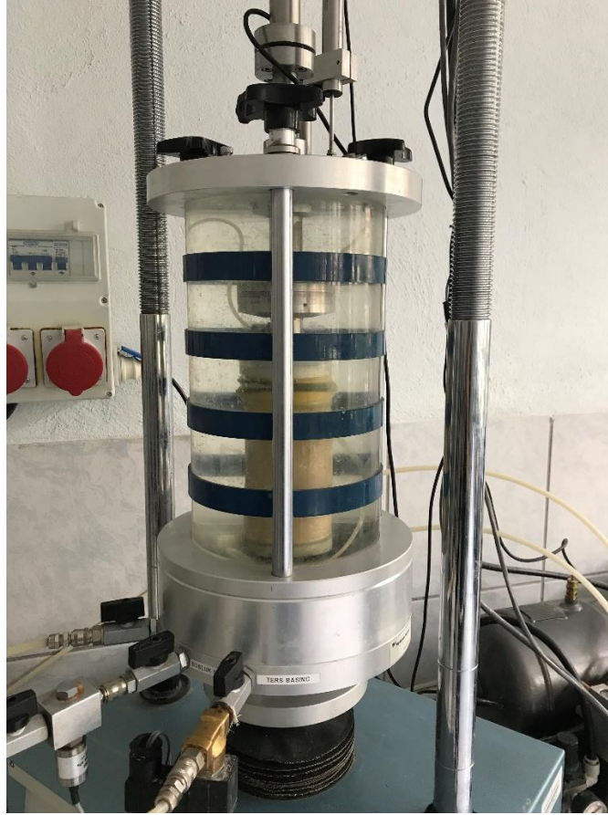
Şekil 2. Dinamik üç eksenli deney sistemi
