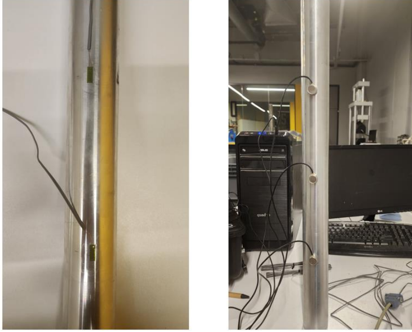
Şekil 1. Model kazık üzerine yerleştirilen gerinim pulları ve gerilme sensörleri
