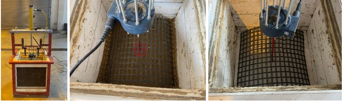
a. Deney düzeneği, b. Geogrid takviyeli uygulama ve c. Geogrid-geotekstil takviyeli uygulama
