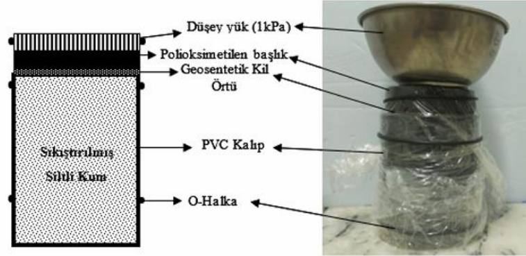
Şekil 1. Hidrasyon deneylerinde kullanılan sistemin şematik ve genel görünüşü
